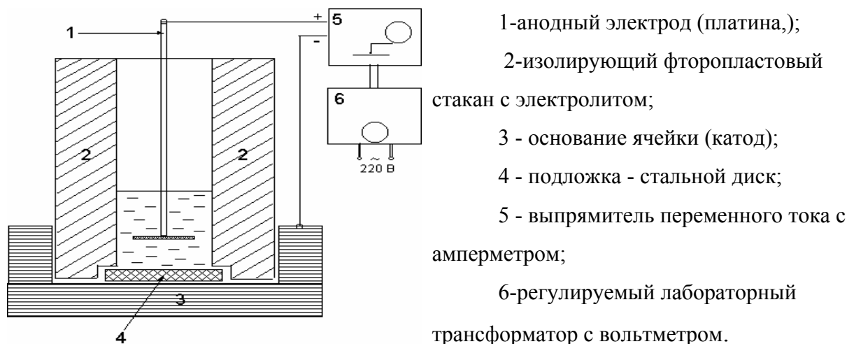
Рис. 3.1. Схема электролитической установки для осаждения изотопов урана
