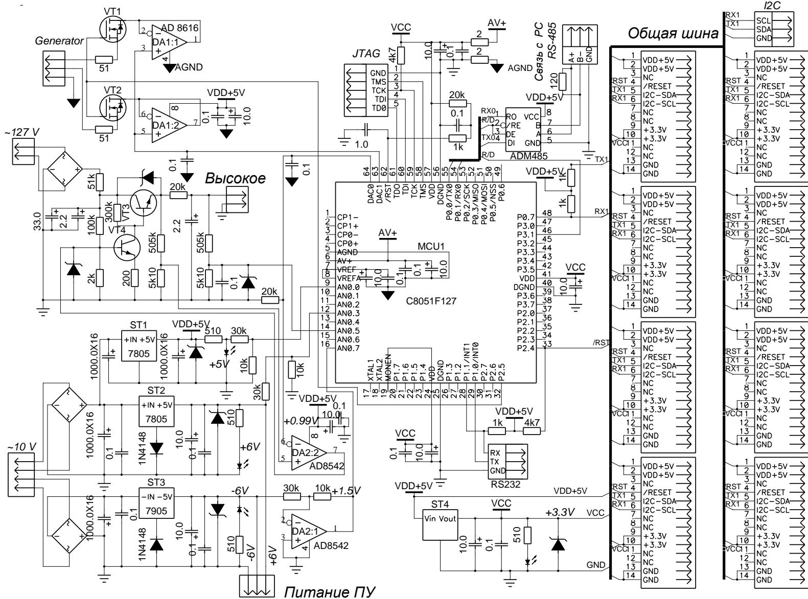
5-расм. Башқариш модули (МУ)нинг принципиал схемаси.
