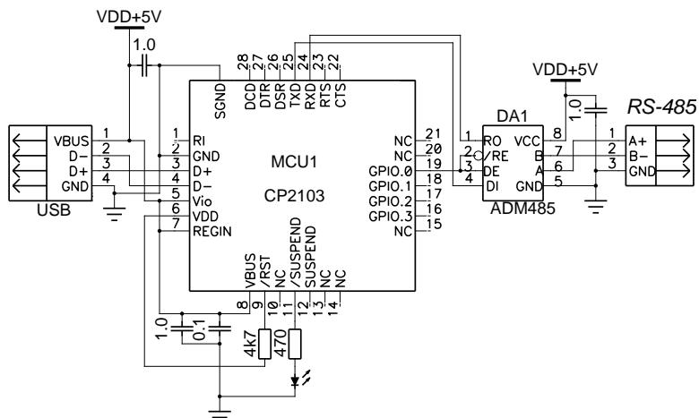
**6-расм - RS485 – USB интерфес кўпригининг принципиал схемаси
