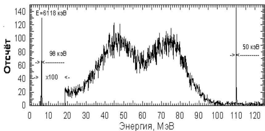
Рис.7. Энергетический спектр от источника  $^{252}\text{Cf}$  (14 стрип).
