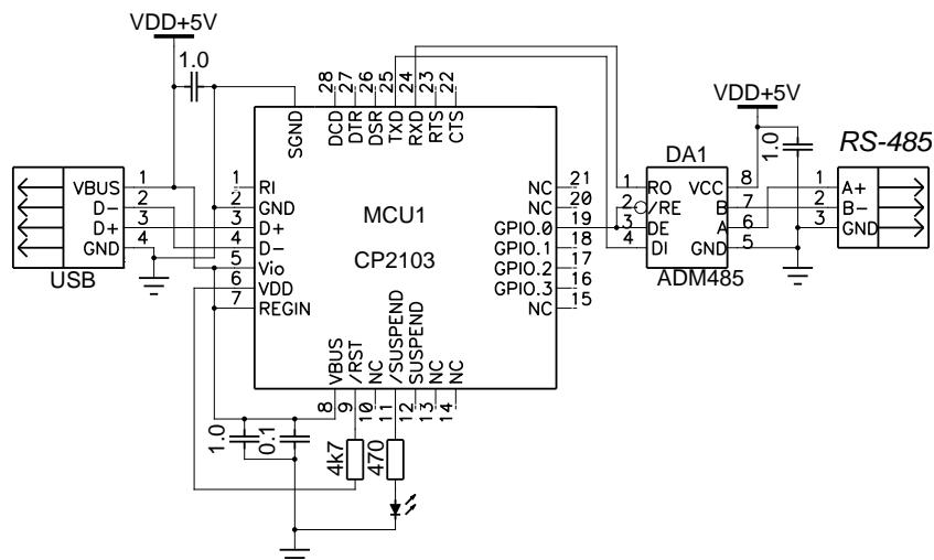
Рисунок 6 - Принципиальная схема моста интерфейса RS485 – USB
