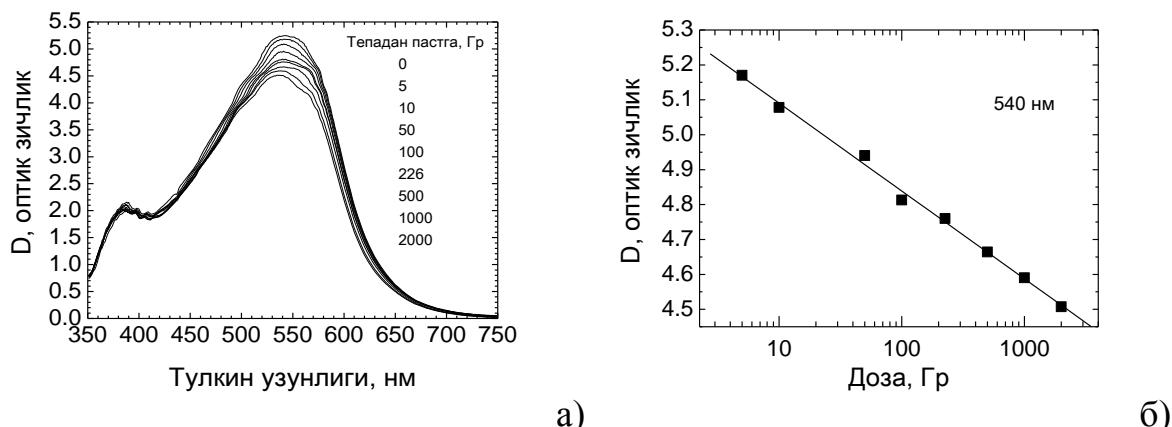
**2-расм. а- визуал рангли суюқ дозиметрининг дозиметрининг сувга нисбатан оптик ютилиш зичлиги спектрлари; б - ушбу спектрнинг 540 нмдаги дозавий боғлиқлиги**
