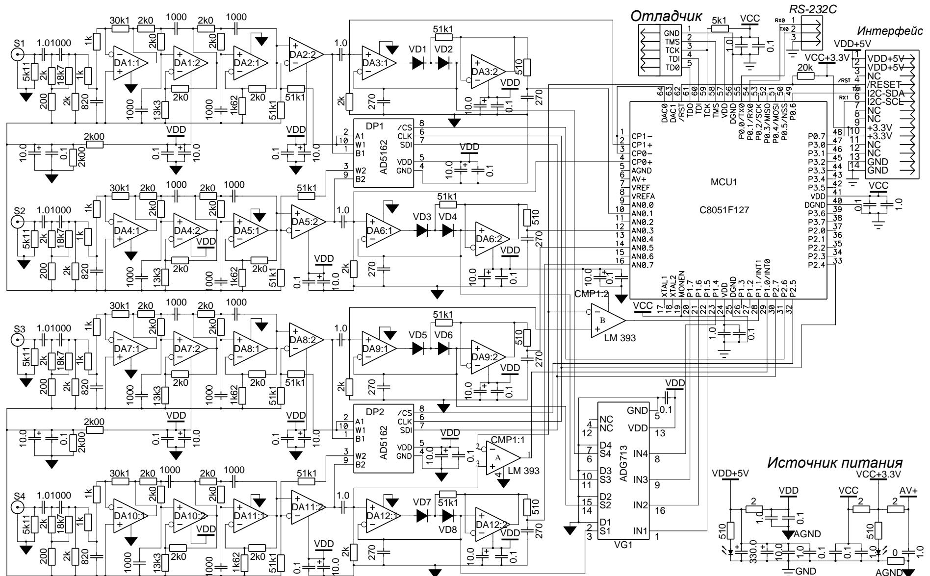
4-расм. Спектрометр модули (MC-4x)нинг принципиал схемаси.
