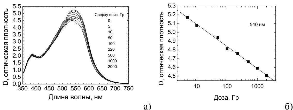
Рис. 2. а - Спектры оптической плотности поглощения жидкостного цветового визуального дозиметра относительно воды, с набором дозы; б - Дозовая зависимость того же спектра на длине волны 540 нм
