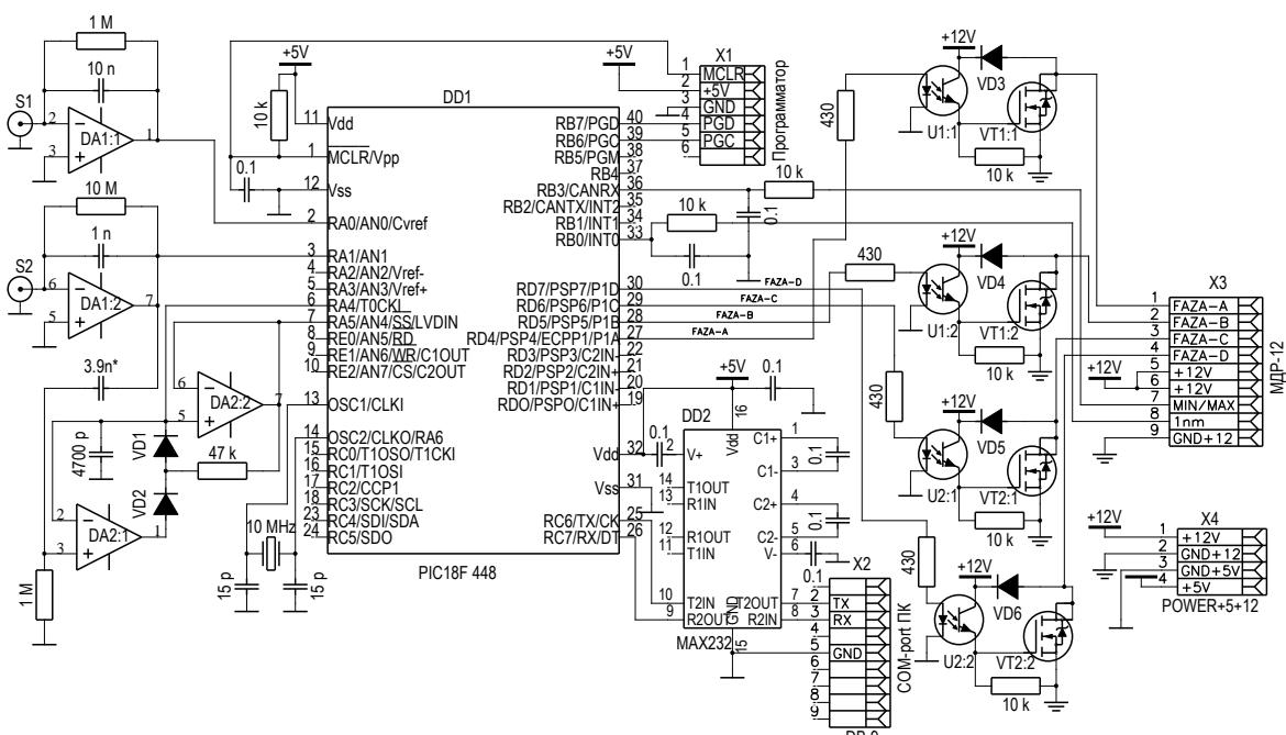
1-расм. Микроконтроллерли модулнинг принципиал схемаси
