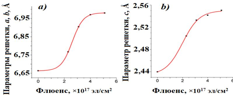
Рис. 3. а) Зависимости параметров элементарной ячейки МСУНТ  $a$  и  $b$  от флюенса электронов: черные точки — экспериментальные результаты (формула (1) с параметрами  $x_0 = 2.01 \times 10^{17}$  эл/см $^2$  и  $d_x = 0.66 \times 10^{17}$  эл/см $^2$ ); б) — кривая зависимости параметра решетки  $c$  МСУНТ от флюенса электронов: черные точки — экспериментальные результаты (формула (1) с параметрами  $x_0 = 2.61 \times 10^{17}$  эл/см $^2$  и  $d_x = 0.43 \times 10^{17}$  эл/см $^2$ )
