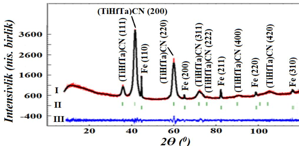
**6-rasm.** Nurlantirilmagan (TiHfTa)CN rentgen difraktogrammasi. I – experimentda kuzatilgan (—) va hisoblangan (—) ma’lumotlar, II – Bregg reflekslari, III – kuzatilgan va hisoblangan ma’lumotlar o‘rtasidagi farq
