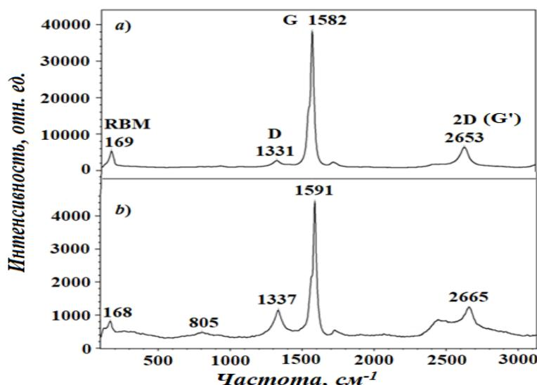
Рис.2. Рамановские спектры ОСУНТ: *a*) исходной, *b*) облученной флюенсом электронов  $1,54 \cdot 10^{17}$  эл/см<sup>2</sup>
