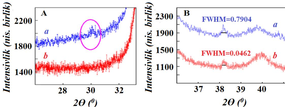
**5-rasm.** (ZrTi)CN ning  $26^\circ$  dan  $33^\circ$  gacha bo‘lgan oraliqdagi (A) va  $36^\circ$  dan  $41^\circ$  gacha bo‘lgan oraliqdagi (B) dastlabki (a) va  $4.1 \times 10^{17}$  el/sm<sup>2</sup> elektronlar flyuensi bilan nurlantirilgan (b) difraktogrammalarini
