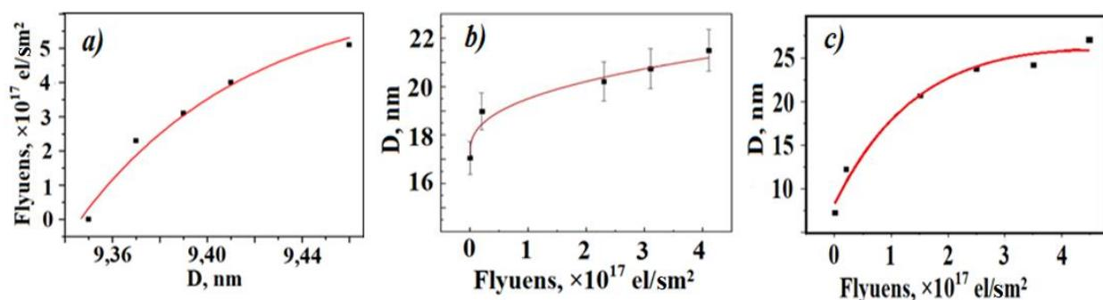
**7-rasm. KDUNN (a), (ZrTi)CN (b) va (TiHfTa)CN (c) namunalar nanokristallitlari o‘lchamlarining elektronlar flyuensiga bog‘liqligi: qora nuqtalar eksperimentdan olingan natijalar**
