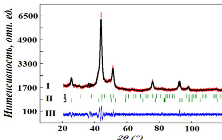
Рис.1. Рентгеновская дифрактограмма исходного ОСУНТ: I – экспериментальные (—), расчетные данные (—), II – Брэгговские рефлексы, III – разность экспериментальных и расчетных данных
