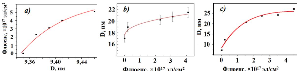
**Рис.7. Зависимости размера нанокристаллитов МСУНТ (a),  $(\text{ZrTi})\text{CN}$  (b),  $(\text{TiHfTa})\text{CN}$  (c) от флюенса электронов: черные точки – экспериментальные результаты**
