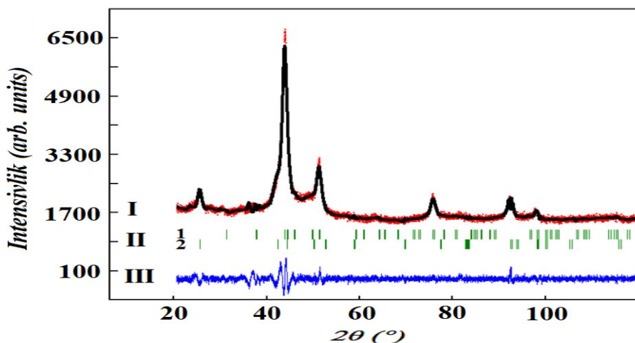
**1-rasm.** Nurlantirilmagan BDUNN rentgen difraktogrammasi. I – eksperimentda kuzatilgan (—) va hisoblangan (—) ma'lumotlar, II – Bregg reflekslari, III – kuzatilgan va hisoblangan ma'lumotlar o'rtasidagi farq
