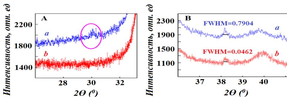
**Рис. 5. Участок дифрактограммы (ZrTi)CN, исходного (a) и облученного электронами  $4,1 \times 10^{17}$  эл/см<sup>2</sup> (b) в диапазоне  $2\Theta_B = 26^0 - 33^0$  (A) и диапазоне  $2\Theta_B = 36^0 - 41^0$  (B)**
