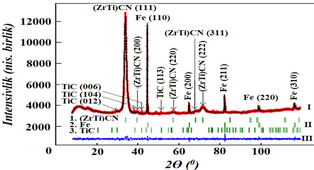
**4-rasm.** Nurlantirilmagan (ZrTi)CN rentgen difraktogrammasi. I – experimentda kuzatilgan (—) va hisoblangan (—) ma'lumotlar, II – Bregg reflekslari, III – kuzatilgan va hisoblangan ma'lumotlar o'rtaisdagi farq
