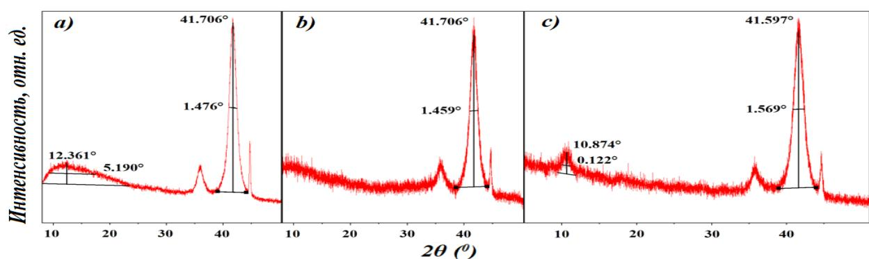
Рис.8. Участок рентгенограммы исходного (a) и облученного флюенсом электронов  $2,5 \times 10^{17}$  и  $4,5 \times 10^{17}$  эл/см<sup>2</sup> (b, c) (TiHfTa)CN
