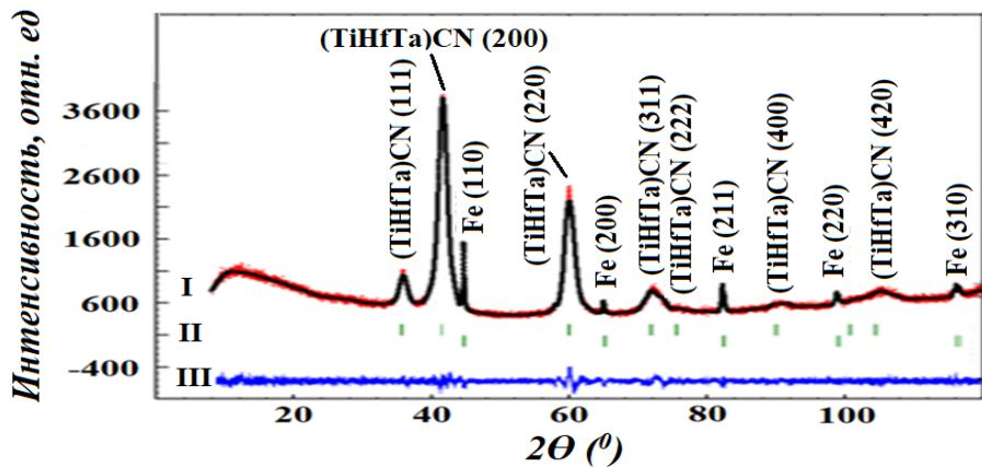
**Рис.6. Рентгеновская дифрактограмма исходного (TiHfTa)CN: I – экспериментальные (—) и расчетные данные (—), II – Брэгговские рефлексы, III – разность экспериментальных и расчетных данных**
