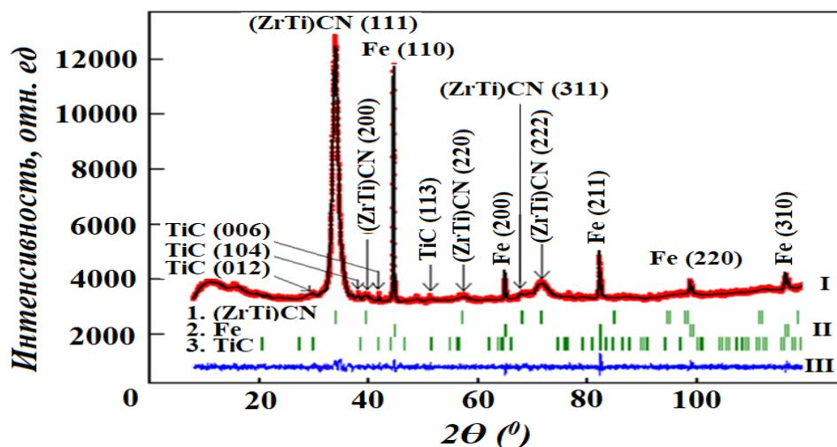
**Рис.4. Рентгеновская дифрактограмма исходного (ZrTi)CN: I – экспериментальные (—) и расчетные данные (—), II – Брэгговские рефлексы, III – разность экспериментальных и расчетных данных**
