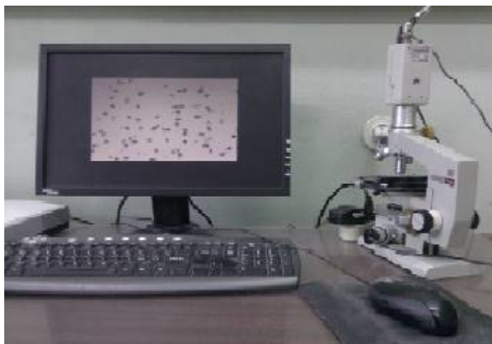
Рис. 2.3. Общий вид оптического устройства, для подсчета трекова- частиц на детекторе CR-39
