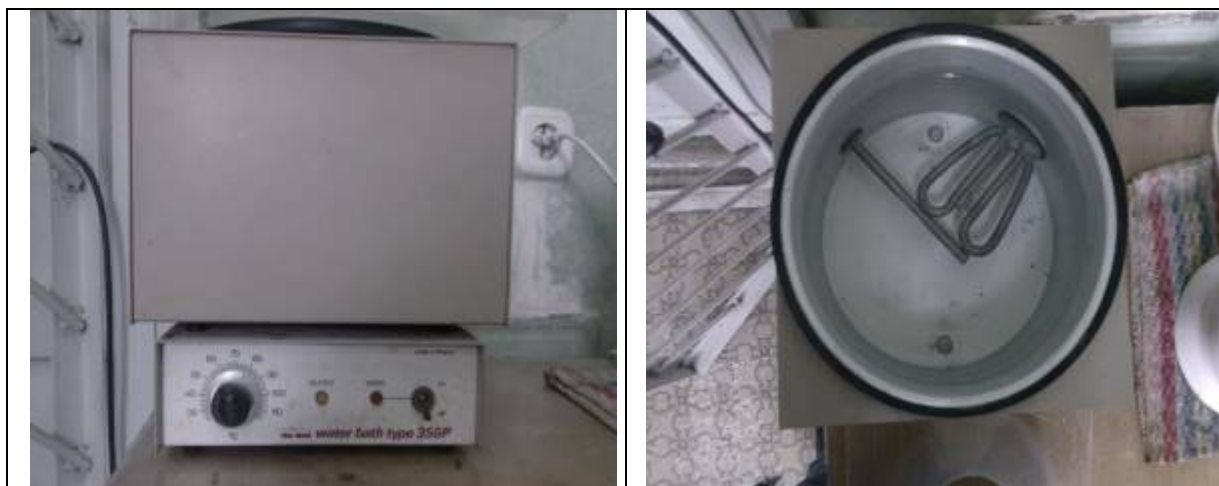
Рис. 2.2. Общий вид ванны для травления CR-39 детекторов
